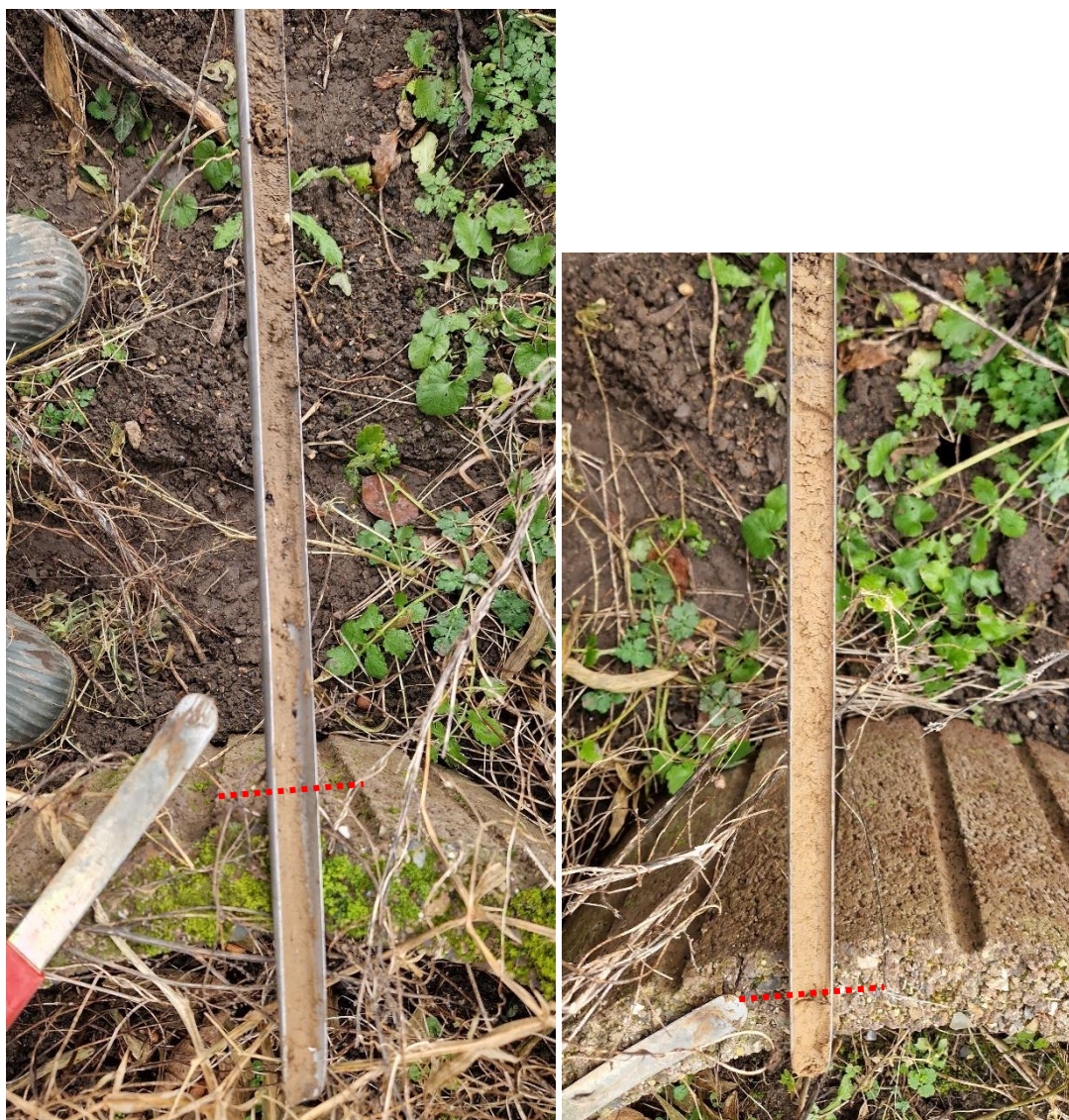
Figuur 20: Foto van gutsboring 3 met aanduiding van de laagovergangen.
