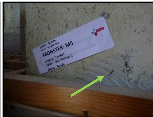
M5 – tegellijm en -voegsel wanden toiletruimte 1 e verdieping is niet asbesthoudend.
