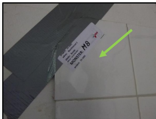
M8 – tegellijm en -voegsel wanden keuken begane grond is niet asbesthoudend.
