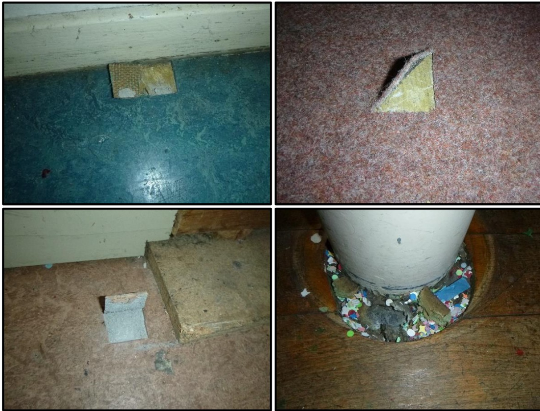
Onderzoeker heeft destructief onderzoek uitgevoerd aan vaste vloerafwerkingen, hierbij zijn geen asbestverdachte toepassingen aangetroffen.
