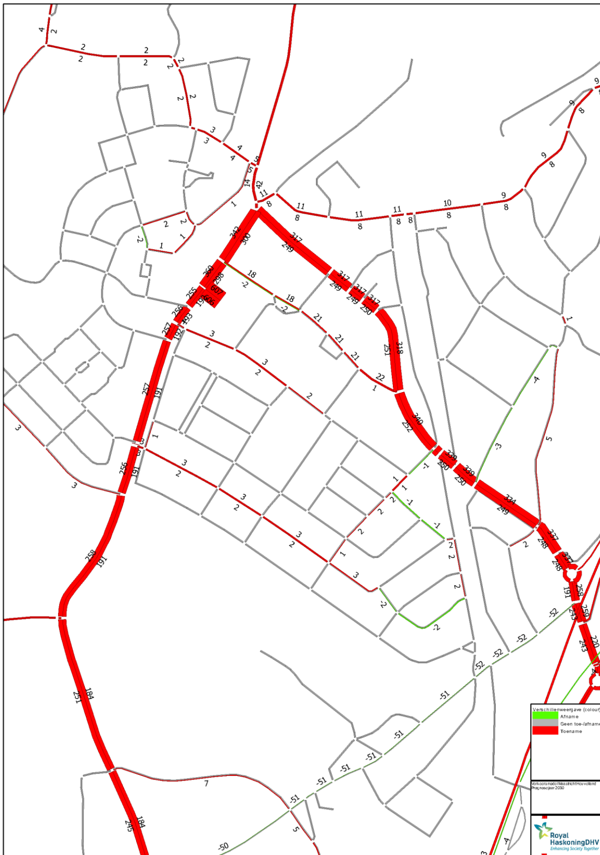
Figuur 4. Verschilplot tussen de het verkeersmodel met en zonder de ontwikkelingen in het centrum van Bunde.
