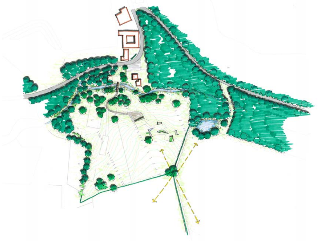
Figuur 14: Voorgenomen ingreep in het onderzoeksgebied. De agrarische bebouwing wordt gesloopt. De aardwoning wordt in de helling gebouwd. Daarnaast worden enkele landschapelementen aangebracht en wordt de overkluizing van de Watervalderbeek opgeheven.
